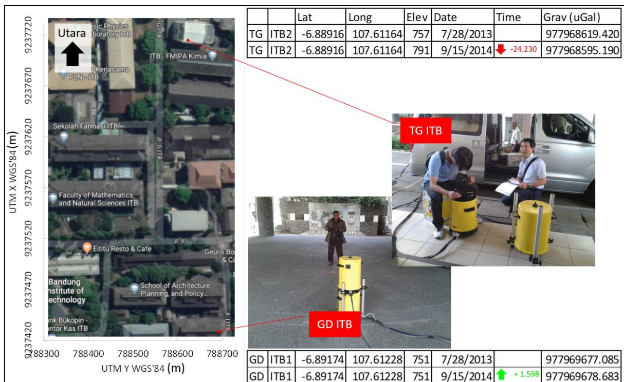
Gambar 4 Dokumentasi kegiatan akuisisi data dengan absolute gravimeter di ITB pada tahun 2014.
